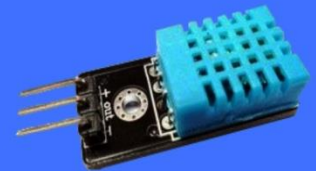
Ηλεκτρονικός αισθητήρας ακριβείας με θερμίστορ
