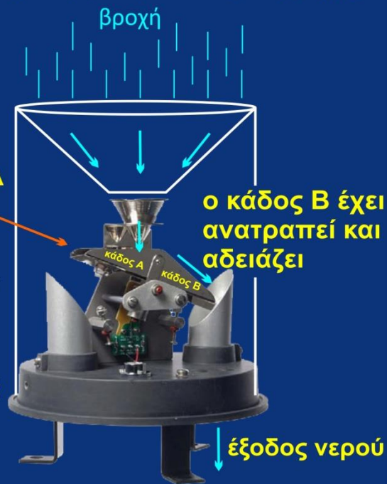
Βροχόμετρο ζυγού ή βροχόμετρο με ανατρεπόμενους κάδους εσωτερικά
