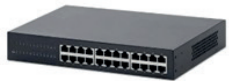
Εικόνα 2.5 Ένας τυπικός μεταγωγέας (switch) με 24 θύρες. Είναι προφανές λόγω του πλήθους των θυρών του ότι μπορεί να δώσει συνδεσιμότητα σε 24 υπολογιστές-συσκευές
