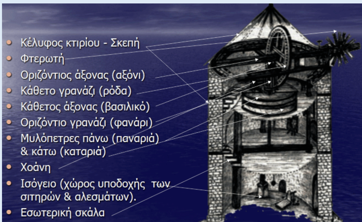
Εικόνα 14η : Η ολική περιγραφή του ανεμόμυλου
